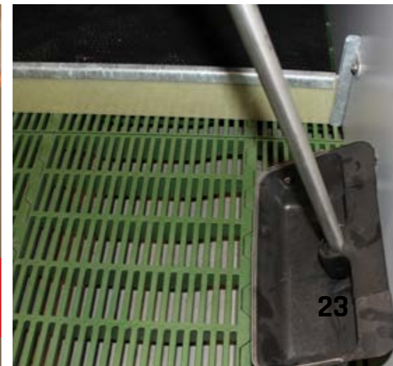
Easy to loosen the bracket on the through for easy cleaning Чтобы помыть поилку достаточно разжать зажим! 方便松开食槽上方的支架进行清洗
